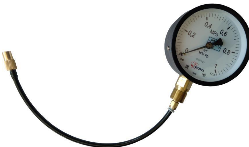
Рисунок 7 – Наконечник с манометром.
