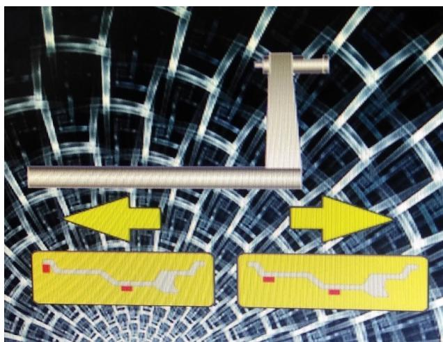
Если выбрана схема установки грузов с двумя грузами на скобах, то штангу надо вернуть в исходное положение. Если станок оснащен датчиком ширины, при опускании защитного кожуха, будет автоматически определена ширина колеса. Если датчик ширины отсутствует, необходимо ввести ширину вручную, перед этим измерив ширину колеса с помощью кронциркуля.
