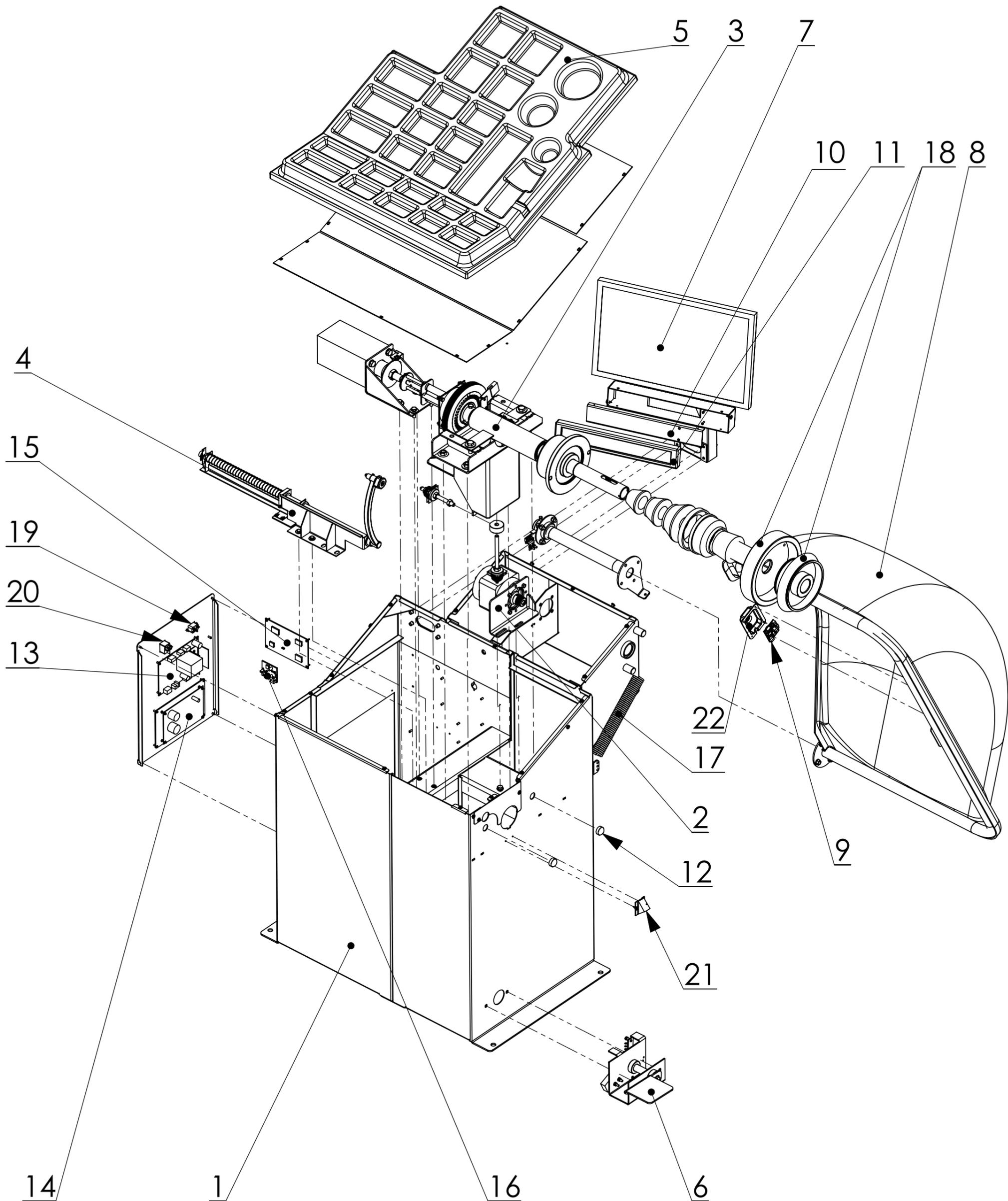
**Спецификация на ЛС4713.00.00.00 Станок балансировочный PROXY 6р**
